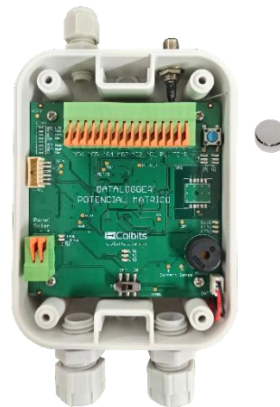
Ubicación de imán para reiniciar el sensor.
